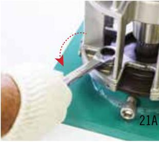
**22** Remove **JIG** using **HEXAGONAL ALLEN TOOL**
